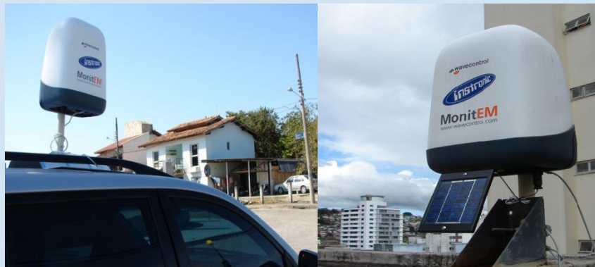
Figura 9: Nuevo sistema de monitoreo de los CEM instalado en un auto, y estación base que utiliza células fotovoltaicas junto con una batería para garantizar el monitoreo continuo sin alimentación eléctrica.
