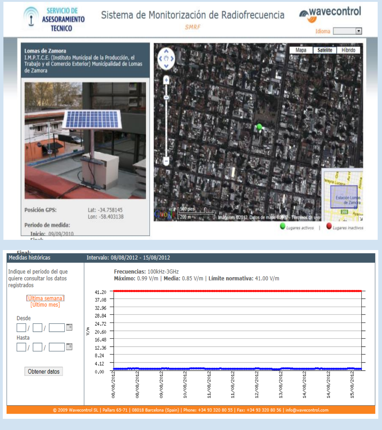
Figura 2: Ejemplo de sistemas de monitoreo continuo en la ciudad de Lomas de Zamora basado en la Recomendación UIT-T K.83
