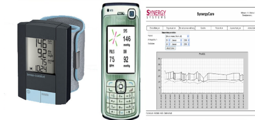
Figure 4: Telemedical, mobile blood-pressure-measuring system of the Heinz Nixdorf-Lehrstuhl für Medizinische Elektronik in cooperation with Sendor GmbH
