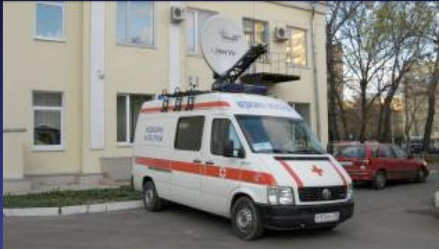
Система высокоскоростной спутниковой связи
