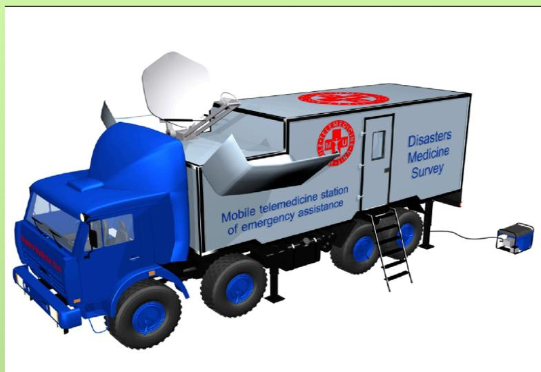
Мобильный телемедицинский пункт экстренной помощи (МТПП) предназначен для оказания экстренной диагностической помощи пострадавшим непосредственно в зоне ЧС.
