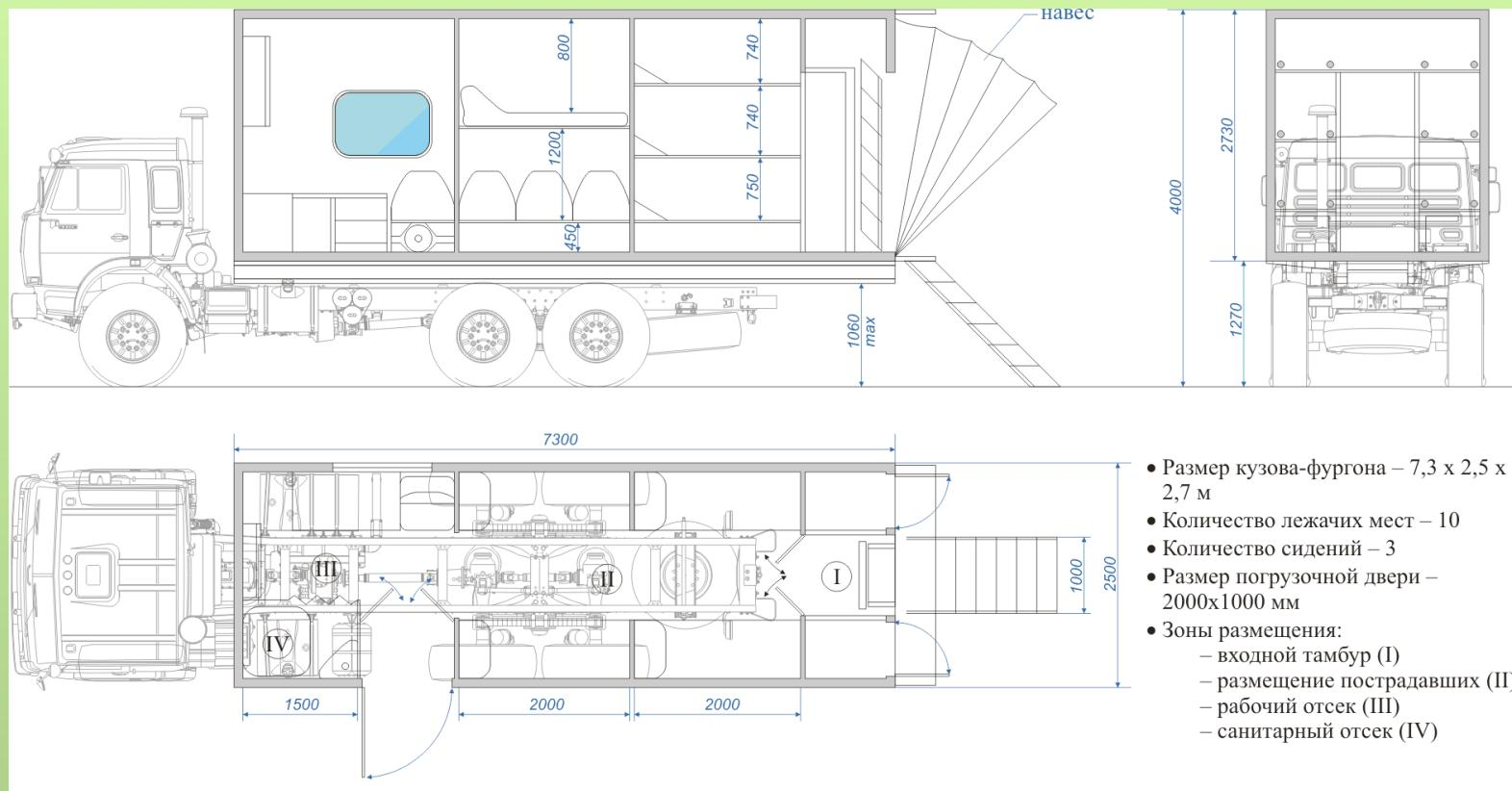
Эвакуатор предназначен для быстрой эвакуации пострадавших в зоне ЧС. смонтирован на шасси типа КАМАЗ-53229 (6x4) с увеличенной длиной базы (до 10 мест для перевозки пострадавших в лежачем положении, 3 места для сидения).
