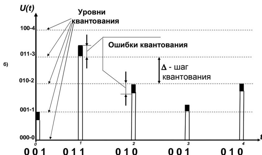
Частота дискретизации  $F_d = 1/T_d > 2F_d$
