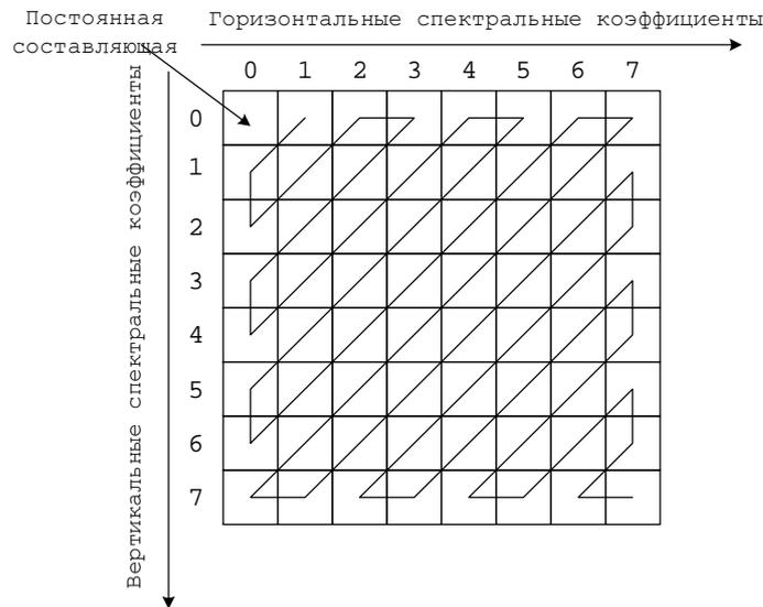
В результате зигзагообразного сканирования образуется последовательность из 63 спектральных коэффициентов, в которой некоторые коэффициенты имеют нулевые значения (нулевые последовательности.)
