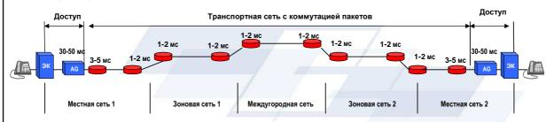
$D_{min}$  = 129 мс,  $D_{max}$  = 181 мс (с учетом задержки распространения сигнала (до 55 мс))
