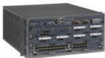
12 слотов (12 под CMA модули, 2 под модули управления/матрицу коммутации)
