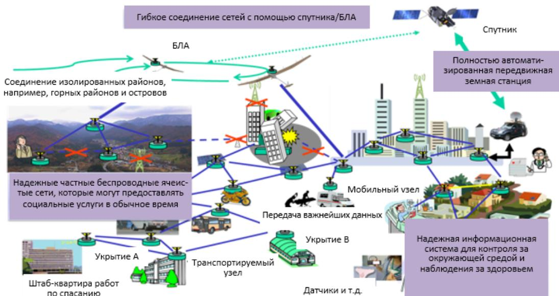
Инфраструктура системы состоит из фиксированных и передвижных релейных узлов ячеистых сетей, размещающихся на вершине зданий или на земле (см. **рисунок 6**). Поэтому ее компоненты должны обладать следующими функциональными возможностями: возможностями подсоединяться к ближайшей местной АТС и/или IP-сети, иметь источник электропитания, необходимыми функциональными возможностями электросвязи, возможностями обеспечения конфиденциальности, безопасности и доступа к транспортной сети.
