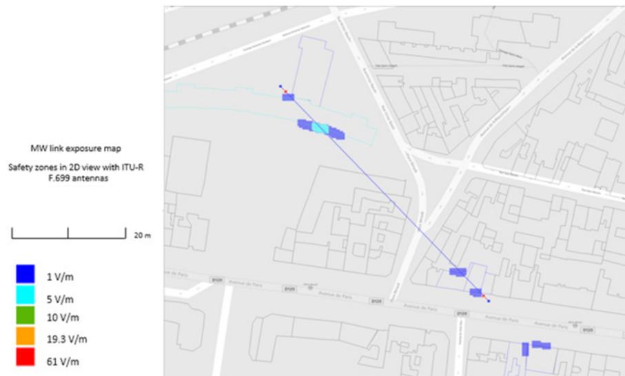
Рисунок 8: Двухмерное представление расстояния воздействия при диаграммах направленности антенн МСЭ-R F.699
