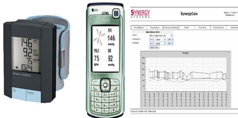
Figure 4: Telemedical, mobile blood-pressure-measuring system of the Heinz Nixdorf-Lehrstuhl für Medizinische Elektronik in cooperation with Sendor GmbH
