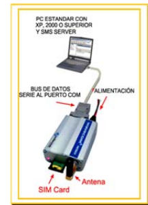
(d) Argentine – service de téléphonie mobile sécurisé pour l'échange de messages; la carte SIM se trouve dans le slot de type Micro-SIM du modem, Escobar (2009)
