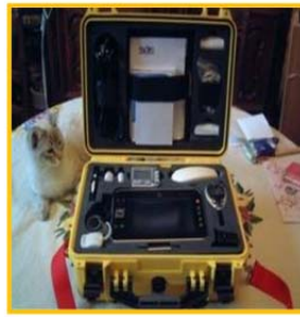
(b) «Solutions nomades» – Equipement sûr et imperméable – ECG, SpO 2 , spiromètre, glucomètre, tests rapides; autonomie: 3 heures, transmission: GSM/GPRS/3G satellite; poids: 3,9 kg, Petitet (2008)
