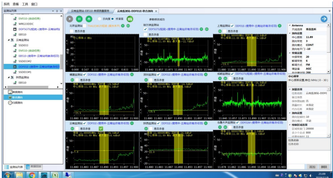
الشكل 9 - المخطط الطيفي على التردد 11 890 kHz
