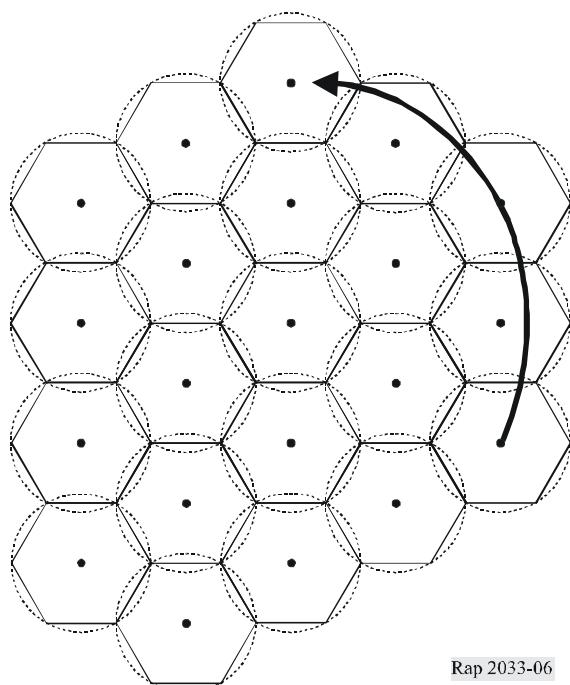
С 12-сотовой моделью повторного использования частот могут создаваться помехи со стороны удаленных подвижных станций работе сот, спроектированных для условий работы с переносными портативными станциями.
