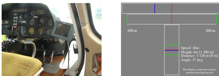
Monitor del piloto y disposición en pantalla
