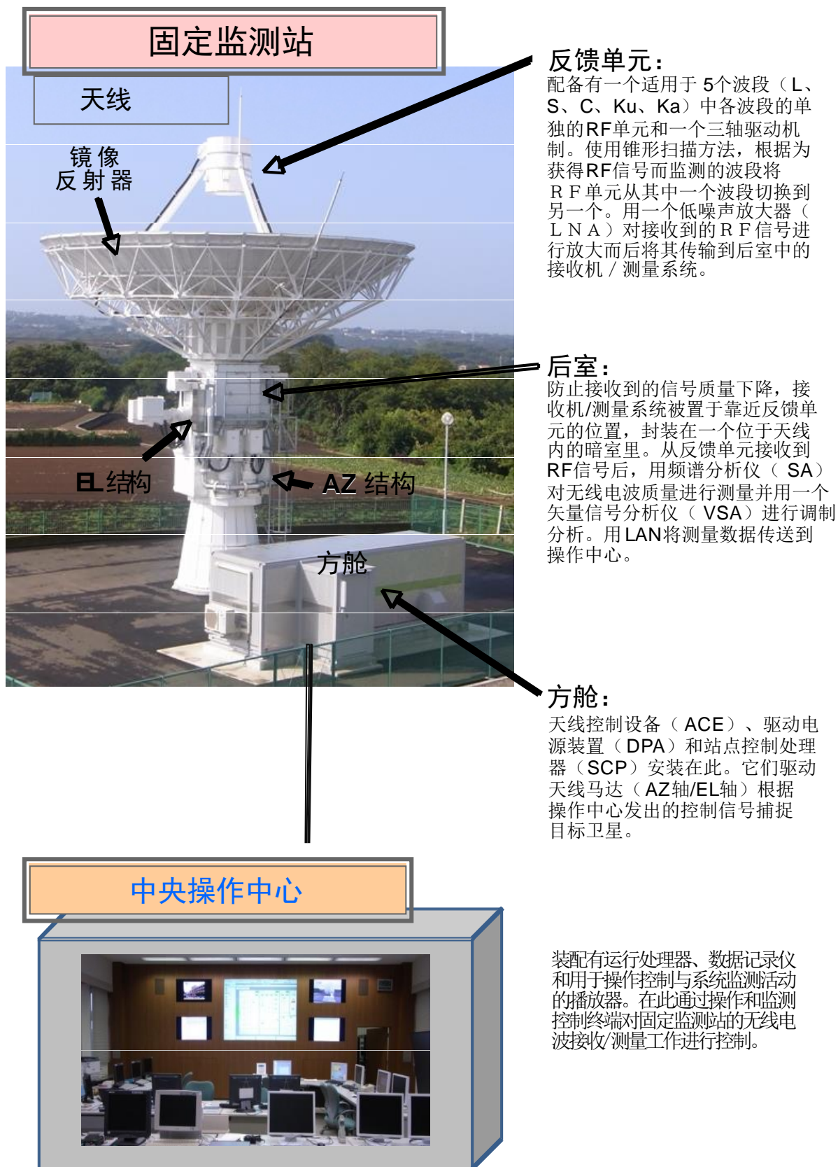
图11 13 m天线的配置
