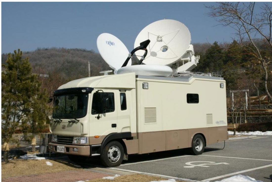
Передвижная система контроля спутниковой радиосвязи
