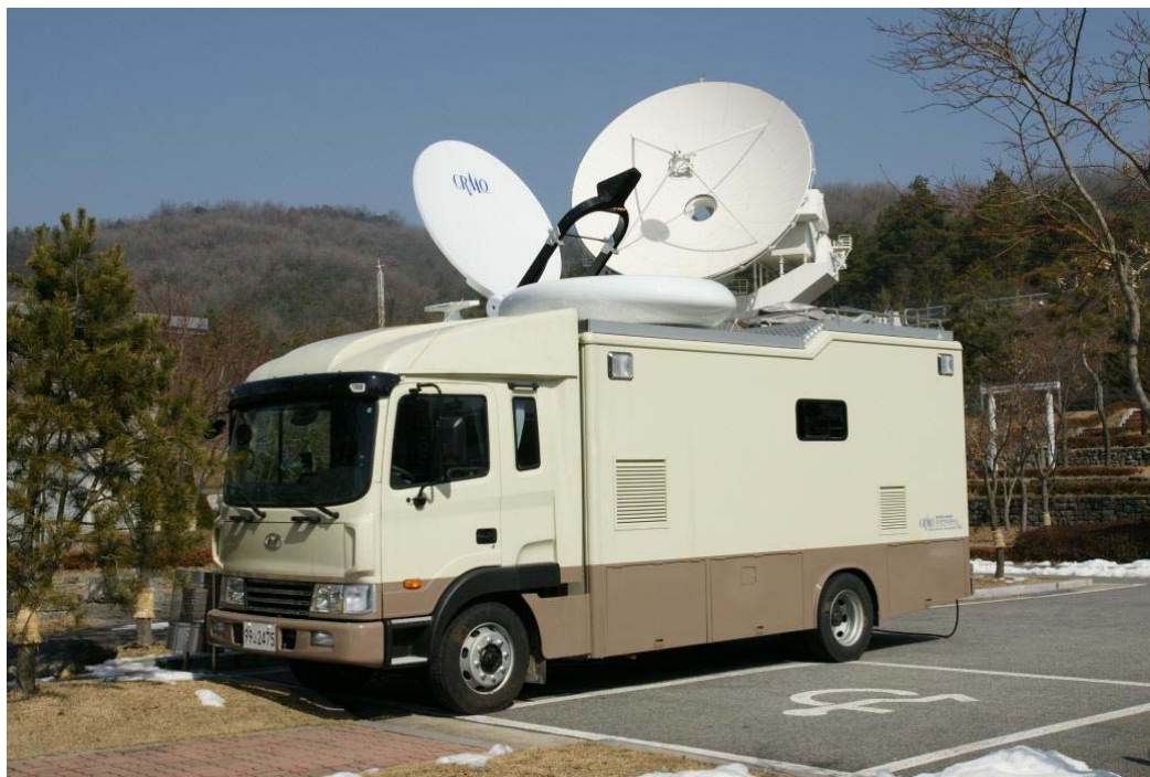
Sistema móvil de comprobación técnica radioeléctrica del satélite
