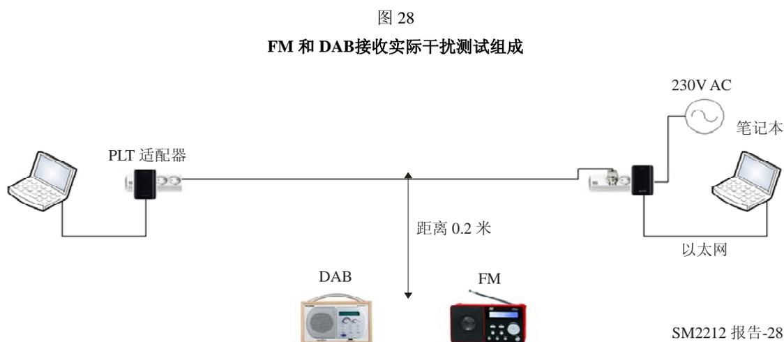
各个Belkin-F5D4076分别被插入三用插座内，其中一个三用插座长度为3米，其电源线被放置在与桌面高度相仿的室内墙上。一个FM收音机（DNT）和DAB收音机（PURE）被放置在电源线前面的桌上。电源线与桌子之间距离在测量期间分若干步骤变动，范围在0-2米之间，以便测量干扰程度。
