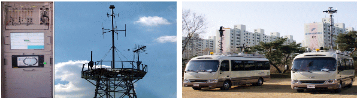
FIGURA 20 Sistema de comprobación técnica fijo (izquierda) y móvil (derecha) para medir la ocupación del espectro
