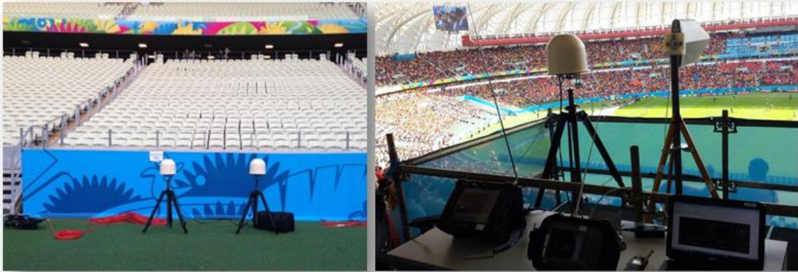
Estaciones de comprobación técnica del espectro de Anatel instaladas en los estadios de la Copa Mundial 2014
