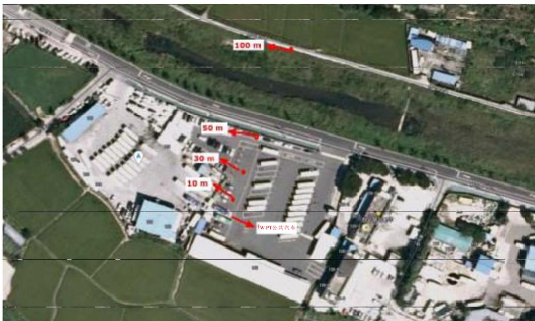
如图A4-2所示，基于固定的1.5 m天线高度，使用环形天线在距WPT公共汽车四个不同的距离处测量H场强度。
