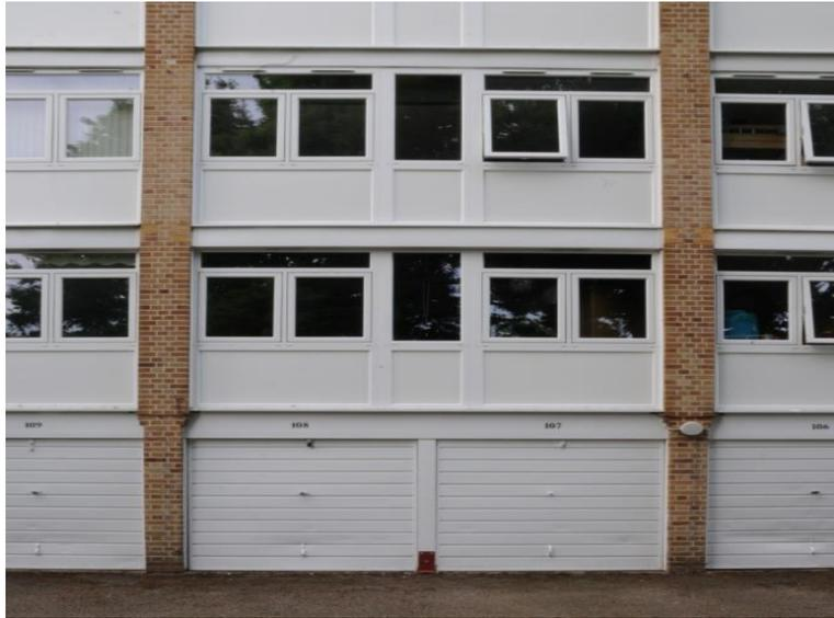
图像显示了伦敦东南部一座公寓的较低楼层。可以看出，底层是建在车库上的，然后是上面的公寓。车库天花板的高度约为2.3 m。可以合理地假设，工作于其中一个最低层的公寓中的无线电接收器可能不会高于车库地板3 m，因此距离至少一个WPT充电器不会超过3 m，它计划用于为车库中的汽车充电。3 m内可能有3个充电器，10 m内可能有多个充电器。可以设想其它场景，当中有一辆汽车可能被充电，并且充电器与邻居公寓中的接收器之间的距离可能不到3 m。磁场随距源头的距离的倒数立方而减小，反之随着接近源头而增加。因此，3 m和10 m处的H场的比是 $(10/3)^3 = 37.0$ 。以dB $\mu$ A/m表示，这是一个差值，大小为 $20 \cdot \log_{10}(37) = 31$  dB。因此，为了在10 m处提供一个相当的场强，必须应用一个大小为31 dB的校正系数。在用于汽车的充电器的情况下，距充电器10 m处的容许磁场强度必须比计算得到的值小31 dB，以保护接收器。其它距离和其它校正因素将不得不用於其它场景。
