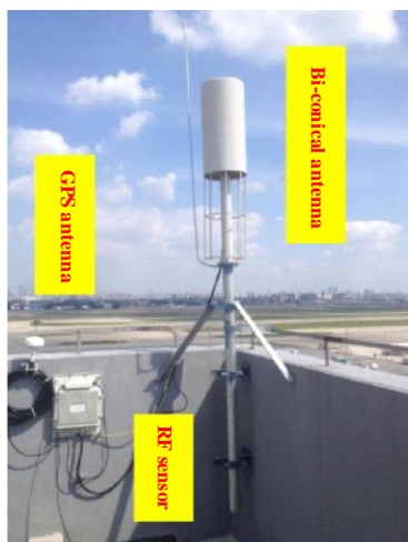
图A2-6 成本效益高的可连网射频传感器和双锥形天线
