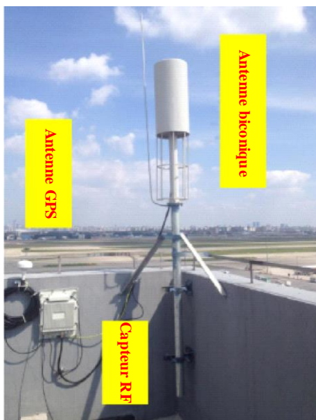
FIGURE A2-6 Capteur RF rentable pouvant fonctionner en réseau et antenne biconique
