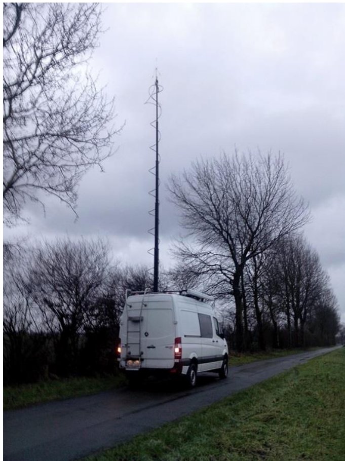
Véhicule de contrôle équipé d'un mât de 10 m et d'une antenne d'émission
