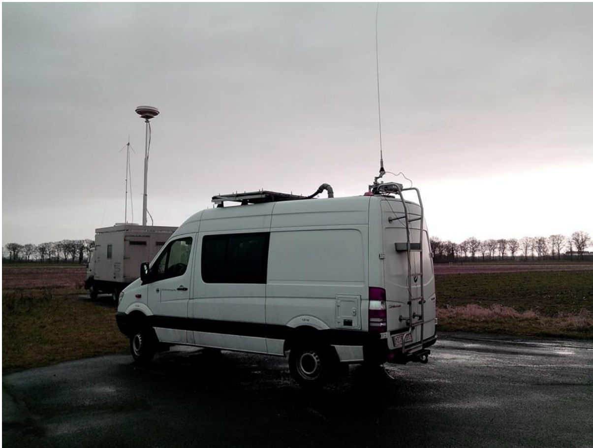
Véhicule de contrôle équipé d'une antenne verticale à ondes décamétriques
