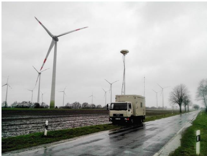
Расположение радиопеленгатора на границе ветряной электростанции
