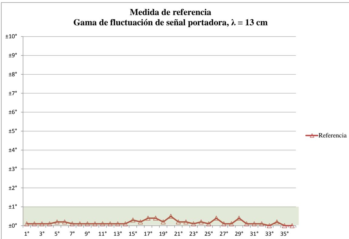
En las bandas de frecuencias de 4 m, 2 m, 70 cm, 30 cm y 23 cm, las mediciones resultantes estaban, en su mayor parte, dentro de la gama de tolerancia para los radiogoniómetros fijos. Solo en las bandas de frecuencias de 2 m y 30 cm se superó ligeramente la gama de tolerancia en 1° en algunas direcciones. Incluso en la banda de 13 cm, especialmente sensible debido a su corta longitud de onda, la gama de tolerancia solo se superó una vez en 2°, y en dos direcciones en 1°.
