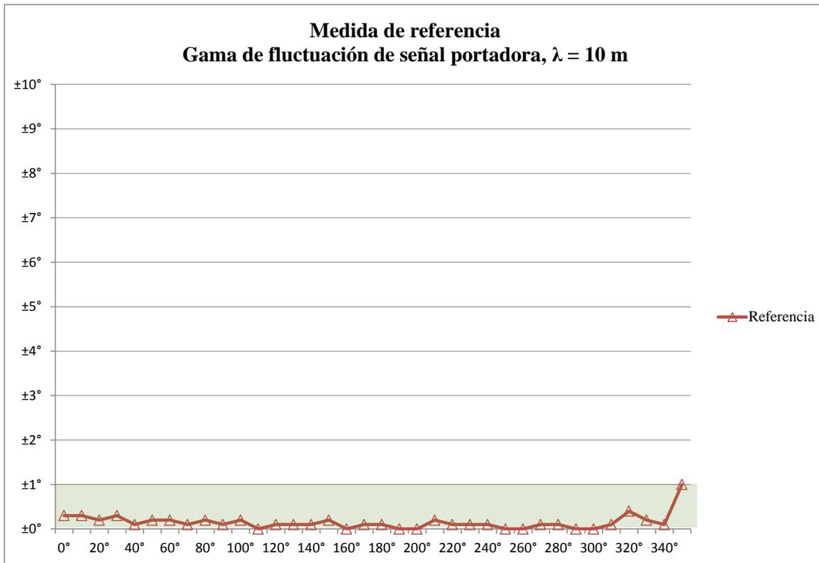
En la banda de 60 m, las desviaciones en los valores DF permanecieron dentro de la gama tolerada (los valores solo superaron  $1^\circ$ ). Por el contrario, en la banda de 20 m se superaron en más de  $10^\circ$ , y en la de 10 m en más de  $7^\circ$ .
