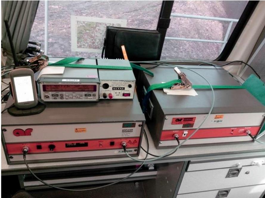
Tras la amplificación (cuando fue necesaria), las transmisiones de la gama de ondas decamétricas (5,46 MHz, 14 MHz y 28 MHz) se generaron utilizando una unidad de sintonía de antena (ATU) y una antena vertical de unos 3 m de longitud.
