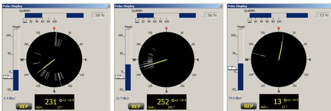
Las líneas blancas muestran el historial de marcación de los últimos 30 segundos, mientras que la línea amarilla muestra la marcación en el momento en que se realizó la captura de pantalla. En el primer ejemplo (banda de 23 cm), la marcación fluctúa de modo caótico en casi todas las direcciones; en el segundo ejemplo (banda de 13 cm), el resultado DF parece fluctuar entorno a un valor promedio. En el tercer ejemplo (banda de 30 cm), hay dos resultados DF extremos, ¡aunque ninguno es correcto!
