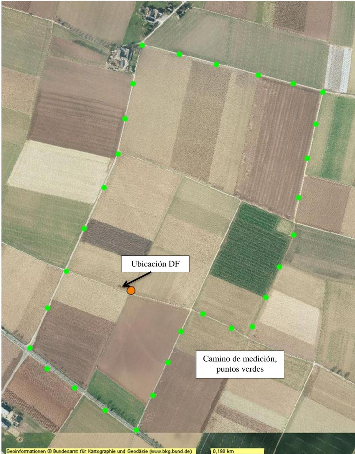
Estas medidas muestran que, en un entorno homogéneo sin interferencias por estructuras como turbinas eólicas, es claramente posible no incurrir en el error DF máximo especificado por el fabricante:  $\pm \leq 2^\circ$  RMS. Para obtener más detalles, véase punto 9.1.
