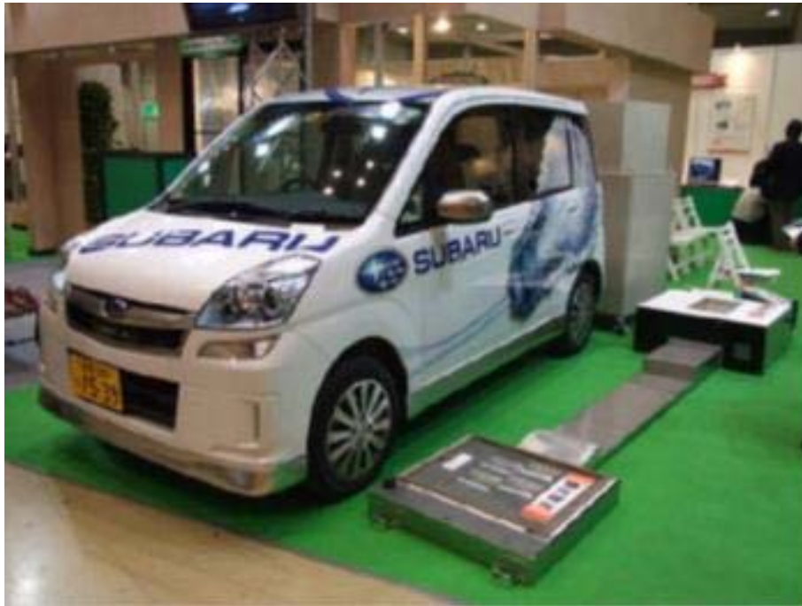
2009年三菱重工集团进行的微波无线充电实验[SHI 13-2]
