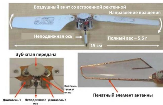
РИСУНОК 2.6.8 Экспериментальная система WPT для БПЛА [NIS 15] и ее демонстрация в Японии (март 2016 года)
