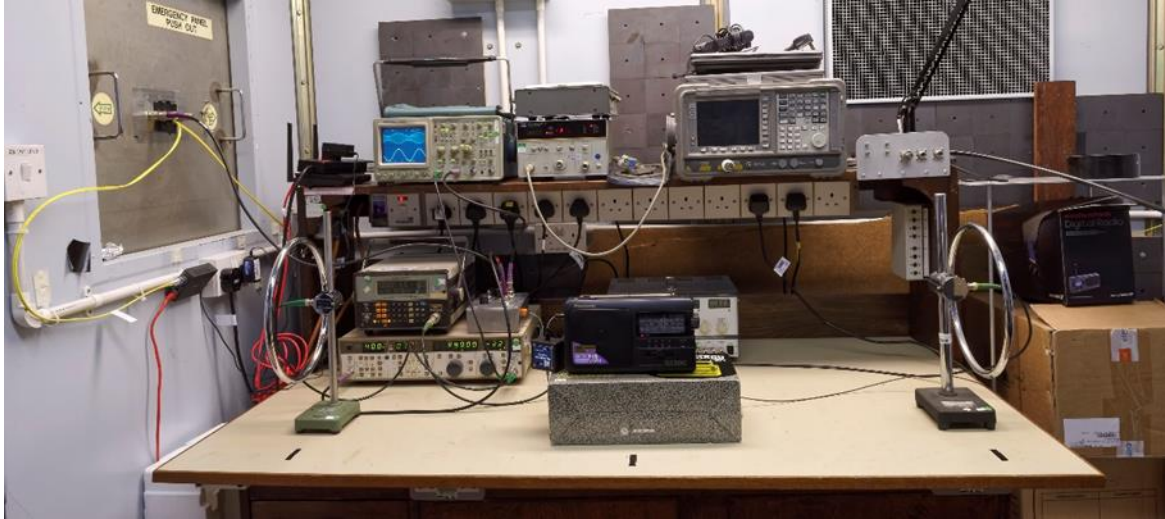
Dispositif d'essai dans la chambre blindée R & D de la BBC
