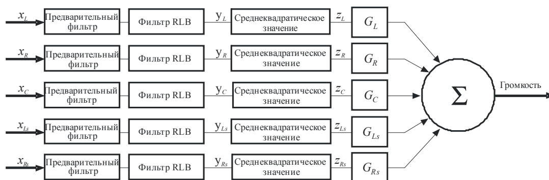
Блок-схема предлагаемого многоканального измерителя громкости
