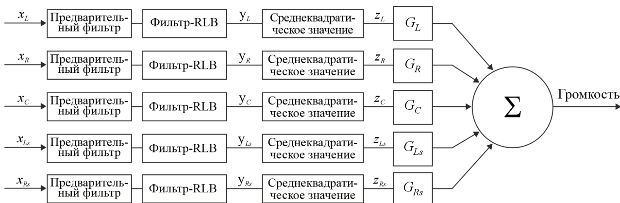
Блок-схема предлагаемого многоканального измерителя громкости
