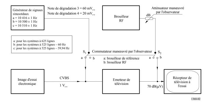
Grâce à un atténuateur qu'il manœuvre lui-même, l'observateur peut faire varier l'intensité du brouilleur RF. Le brouilleur RF est ajusté pour produire la même note de dégradation, les images brouillées étant comparées sur l'écran de télévision.
