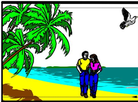
Ejemplo 1 - Formato de imagen de 4:3 extraído de fuente de 16:9 mostrando el encuadre y la zona de acción de 14:9 vertical residual. Se mantiene la altura original de la imagen pero se recorta la anchura aproximadamente al límite de acción de 14:9. Sin barras negras.
