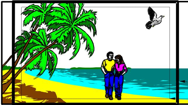
Imagen de 16:9 según se ve en la cámara y en presentación visual de pantalla grande mostrando las retículas de pantalla de visor de la cámara propuestas para el encuadre de 14:9 y zona de acción de 14:9 (90% de la anchura/altura de la zona de encuadre de 14:9).
