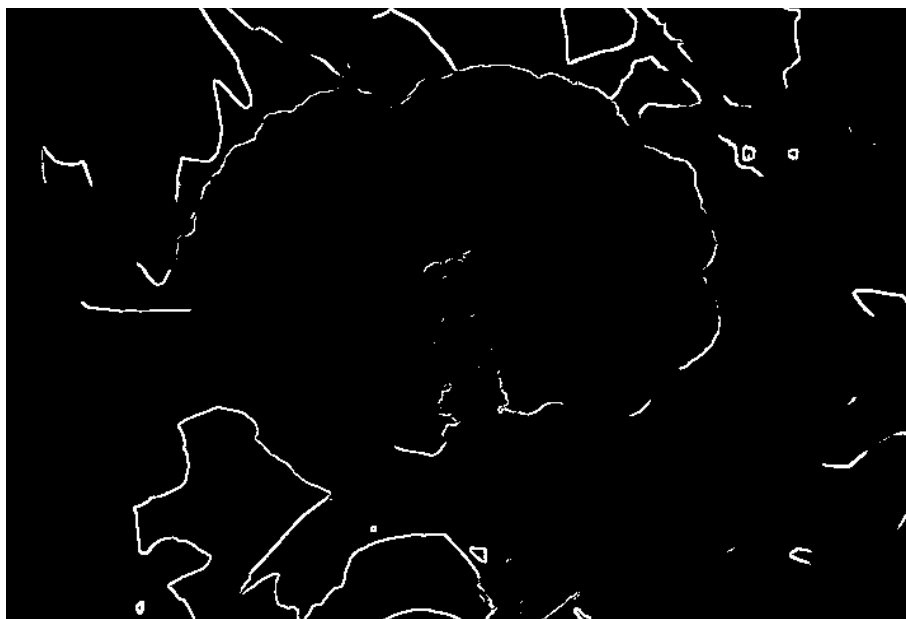
二值边缘图像（掩模图像），该图像是通过图5的梯度幅度图像应用阈值运算得到的
