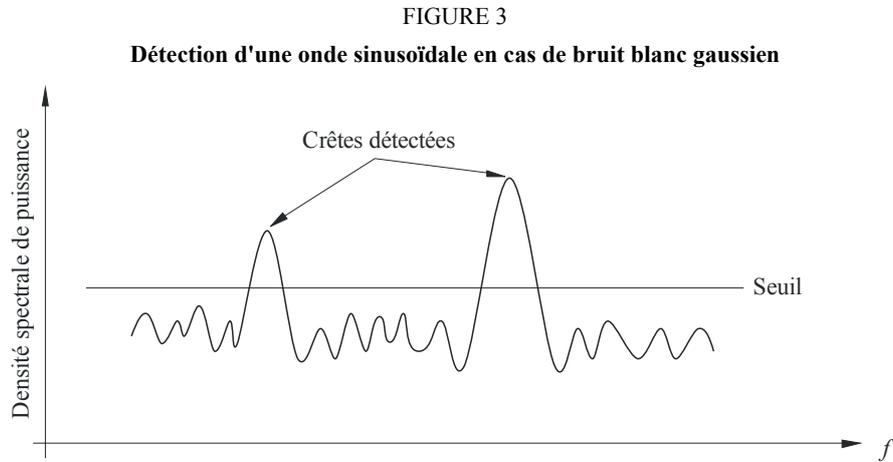
Les signaux dont la puissance dépasse le niveau de seuil sont attribués à une unité de récupération de données (DRU, *data recovery unit*) embarquée pour traitement supplémentaire et transmission vers la Terre sur le canal de télémétrie prévu pour la mission (voir la Fig. 4).
