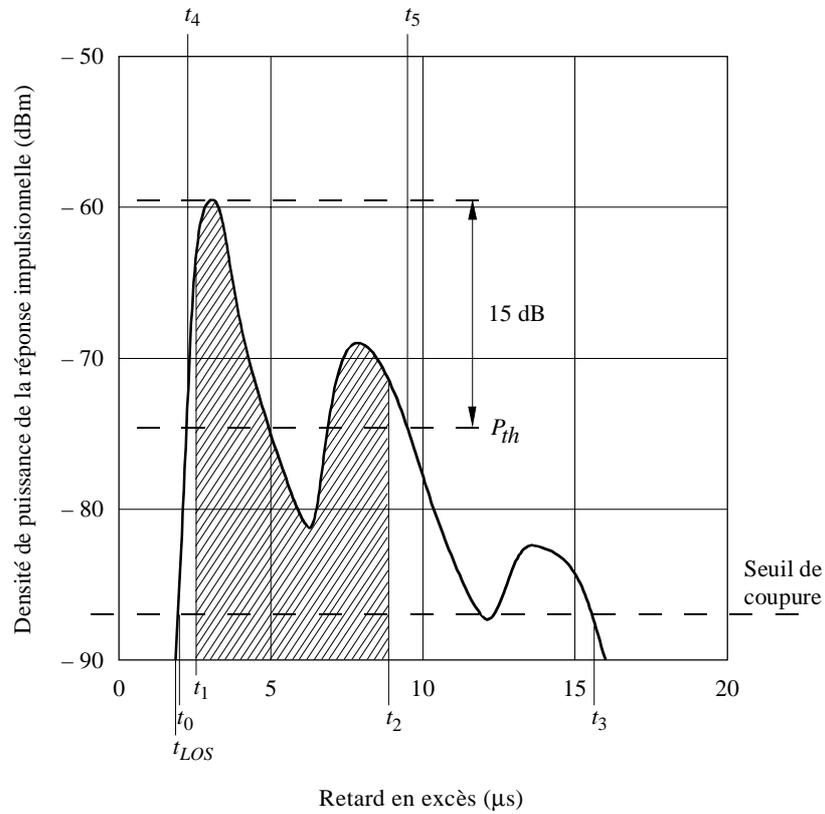
La fenêtre des retards,  $W_{90}$ , contenant 90% de l'énergie reçue est indiquée par des hachures. L'intervalle des retards,  $I_{15}$  contenant le signal au-dessus du niveau «15 dB en dessous de la valeur de crête» s'étend entre  $t_4$  et  $t_5$
