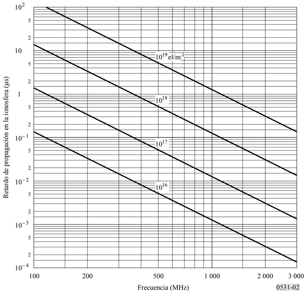
En una banda de frecuencias en torno a 1 600 MHz, el retardo de grupo de la señal varía entre aproximadamente 0,5 y 500 ns para un CET de  $10^{16}$  a la  $10^{19}$  el/m<sup>2</sup>. La Fig. 3 muestra el porcentaje anual de las horas diurnas para las que el retardo de propagación rebasará los 20 ns en un periodo de actividad solar relativamente intensa.
