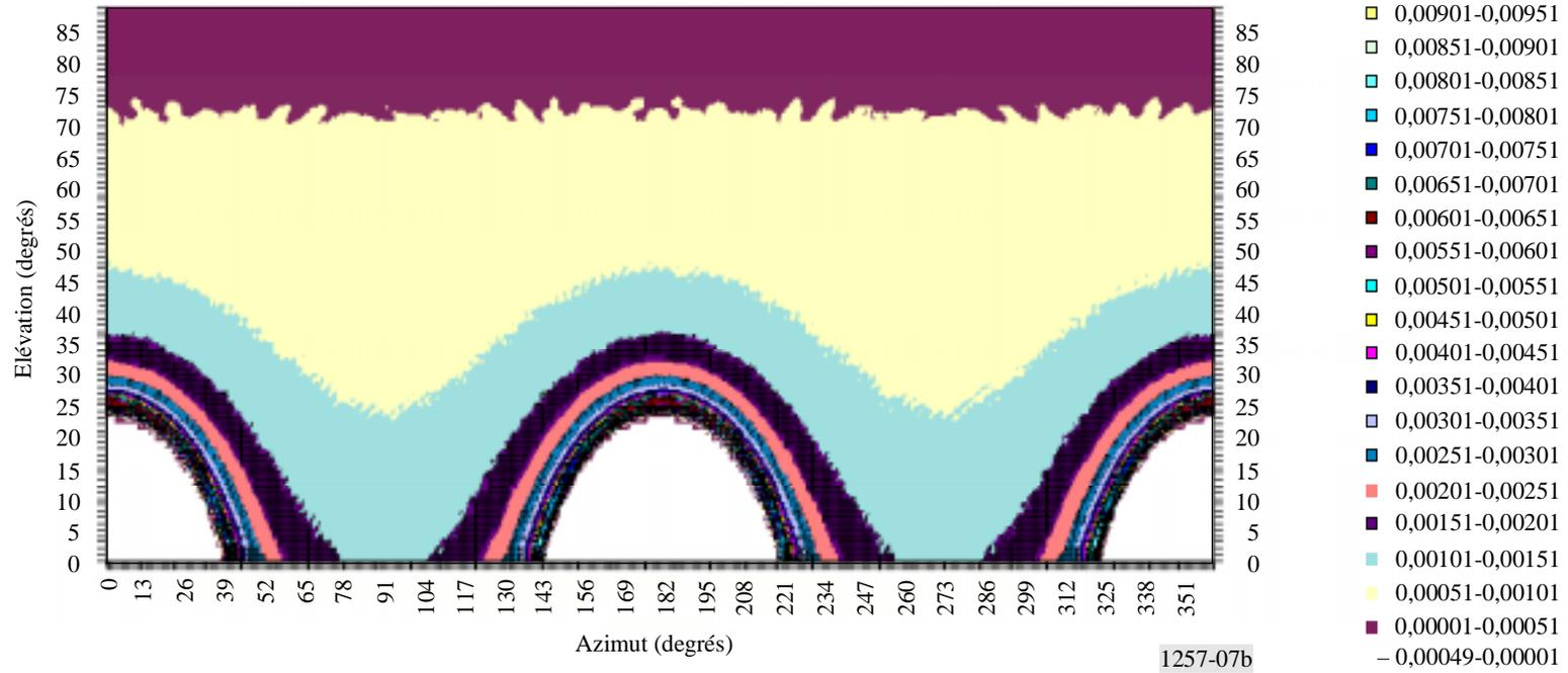
D'après les équations (28) et (29), les azimuts sont symétriques par rapport au nord ( $\Lambda = 0^\circ$ ) et au sud ( $\Lambda = 180^\circ$ ). Ils ne dépendent que des paramètres  $L_0$ ,  $\varepsilon$ ,  $h$  et  $i$ .
