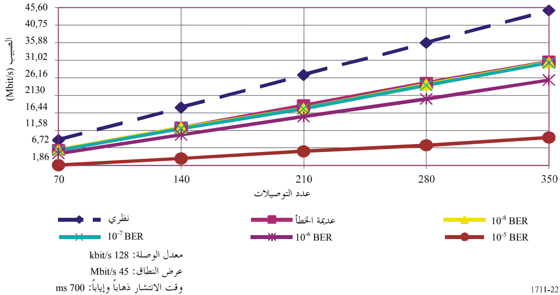
الشكل 22 توصيلات بروتوكول TCP متعددة على وصلة بساتل بدون تحسين
