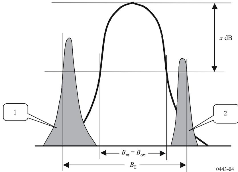
Lorsqu'on ne sait pas si les spectres 1 et 2 concernent des signaux brouilleurs, on peut identifier les émetteurs brouilleurs à l'aide d'un corrélomètre à deux canaux, indiquant une valeur faible pour le coefficient de corrélation entre le signal correspondant au spectre de l'émission considérée et le signal du brouilleur potentiel (§§ 4.4.5.4, 4.8.5.5, 4.8.5.6 du Manuel de l'UIT-R – Contrôle du spectre (édition de 2011)).
