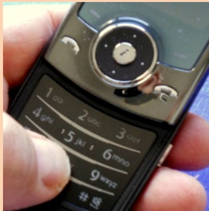
Figure 1.4: Téléphone Samsung muni de points en relief sur la touche n°5
