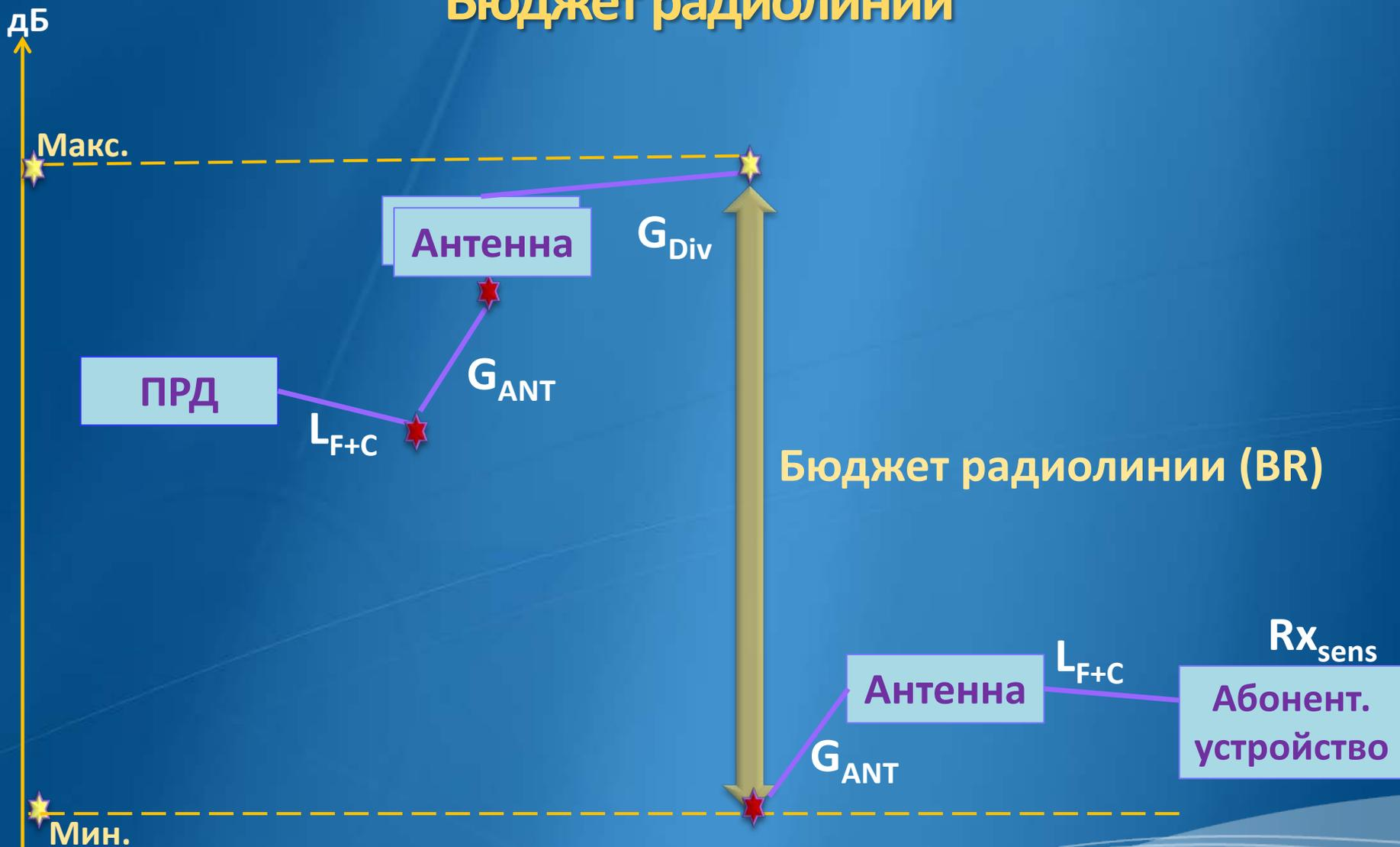
$$BR_{DL} = (P_{TX} - L_{F+C} + G_{ANT} + G_{Div}) - (Rx - G_{ANT} + L_{F+C})$$
