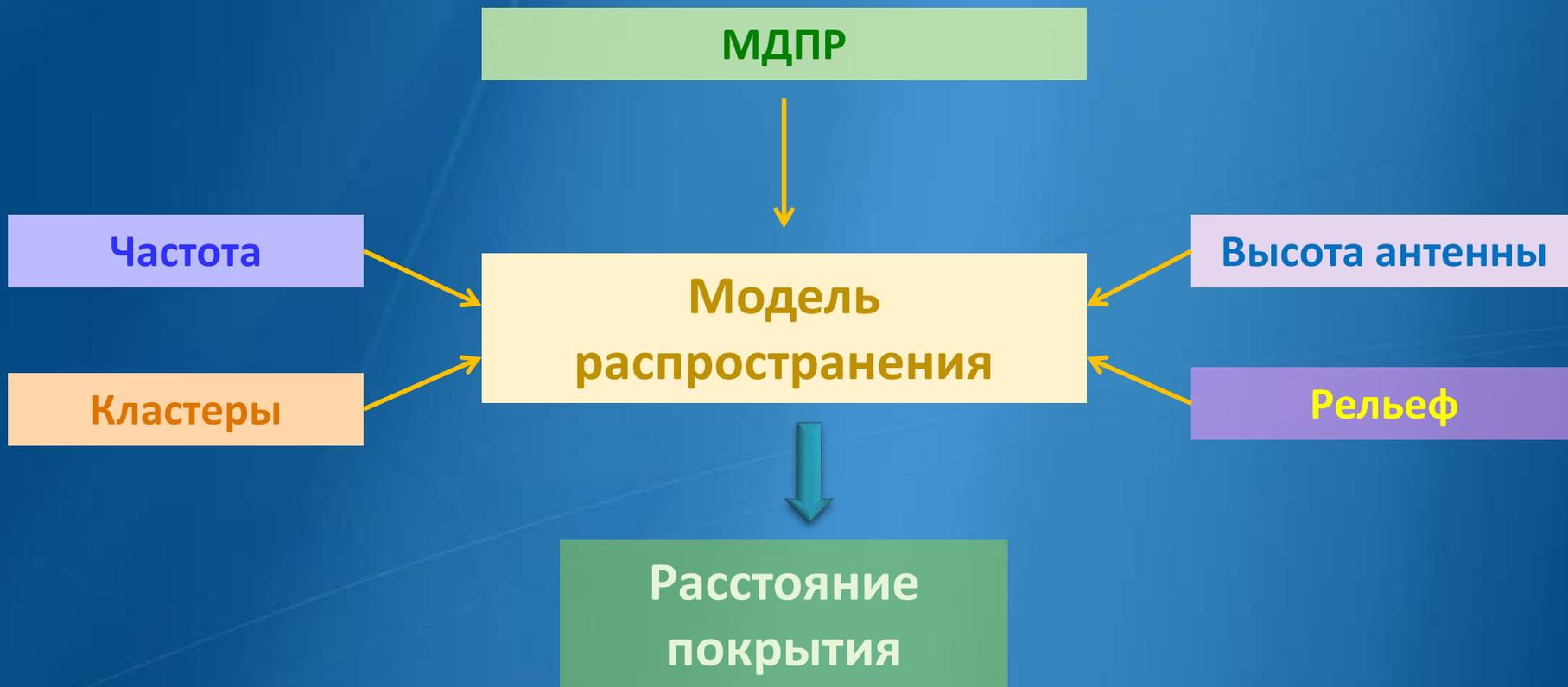
Бюджет радиолинии служит для расчета размера соты, используя соответствующую модель распространения
