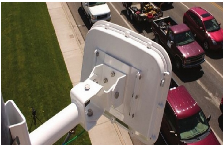
Радиолокационный транспортный детектор WAVETRONIX
