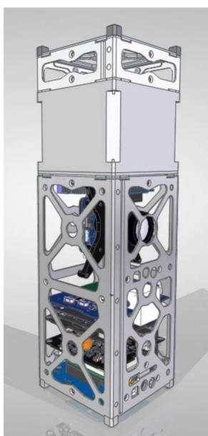
Fig. 2 – Modelo 3D subsistemas del Libertad 2
