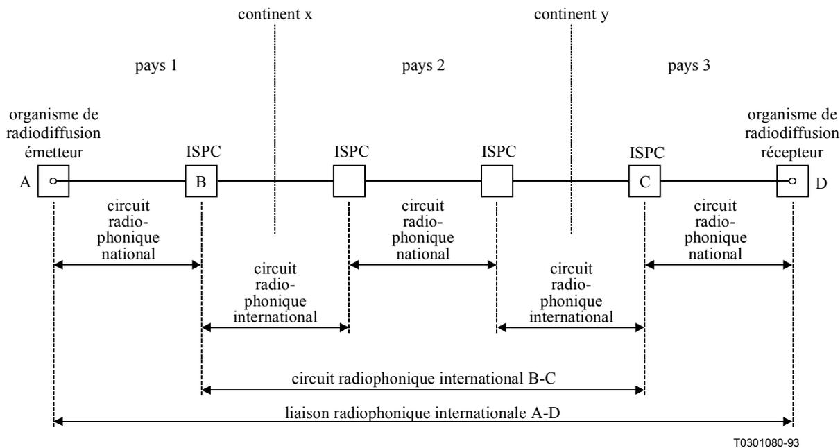
**Figure 1/D.180 – Exemple de liaison radiophonique internationale**
