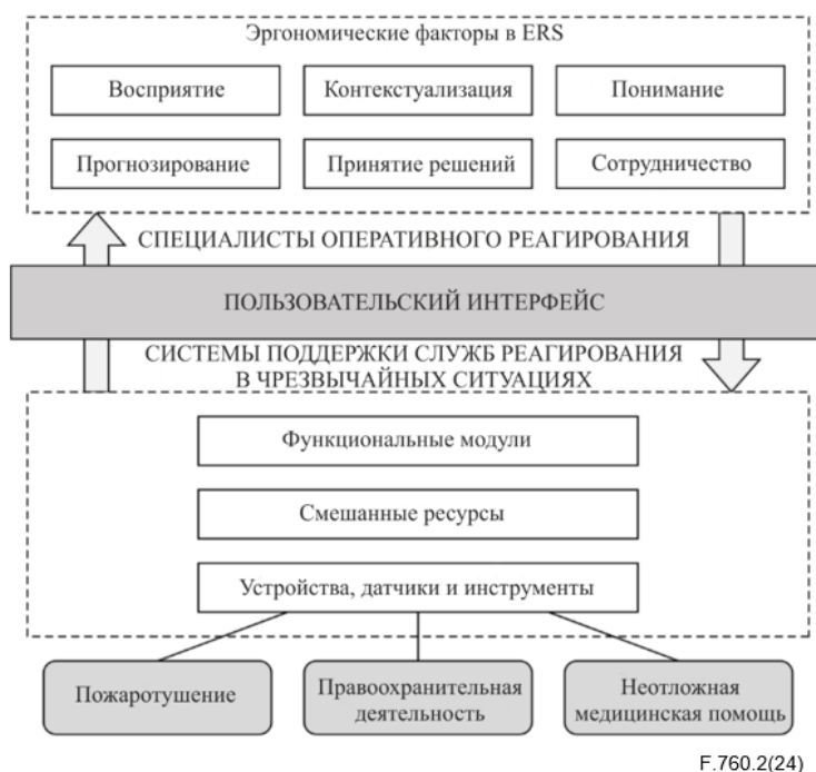
Рисунок 1 – Эргономические факторы и пользовательский интерфейс в системах поддержки служб реагирования в чрезвычайных ситуациях
