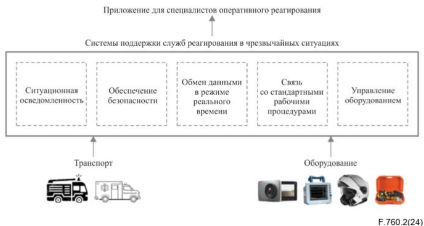
Рисунок 2 – Функциональные модули систем поддержки служб реагирования в чрезвычайных ситуациях
