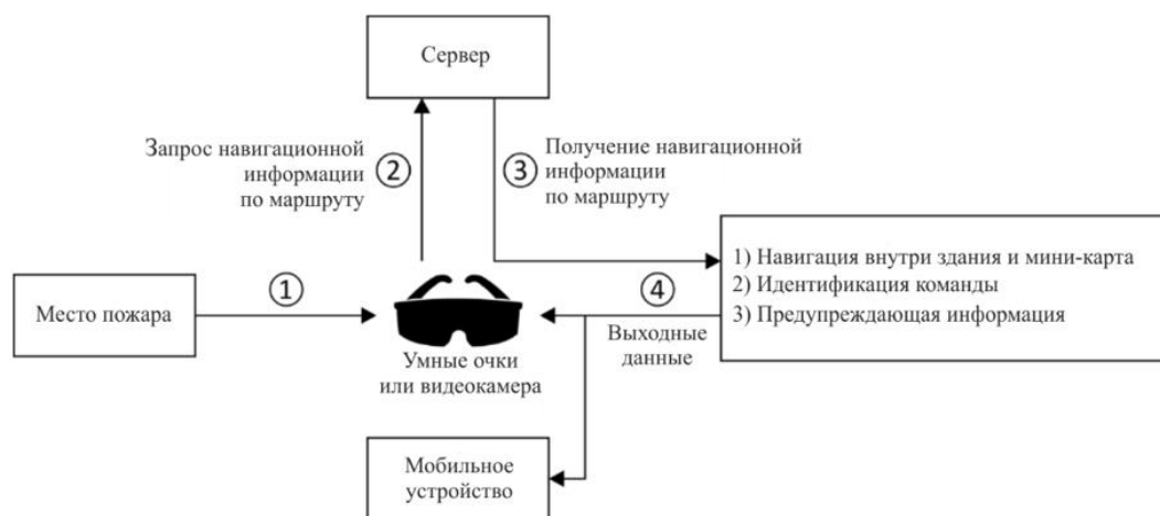
Рисунок I.3 – Порядок действий поисково-спасательной бригады с использованием умных устройств для пожарных
