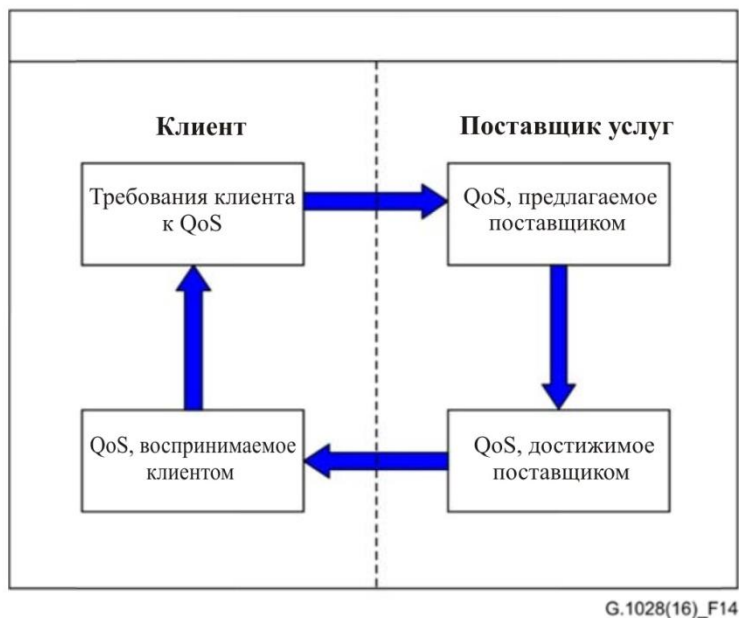
Рисунок 14 – Четыре точки зрения на QoS (источник [ITU-T G.1000])
