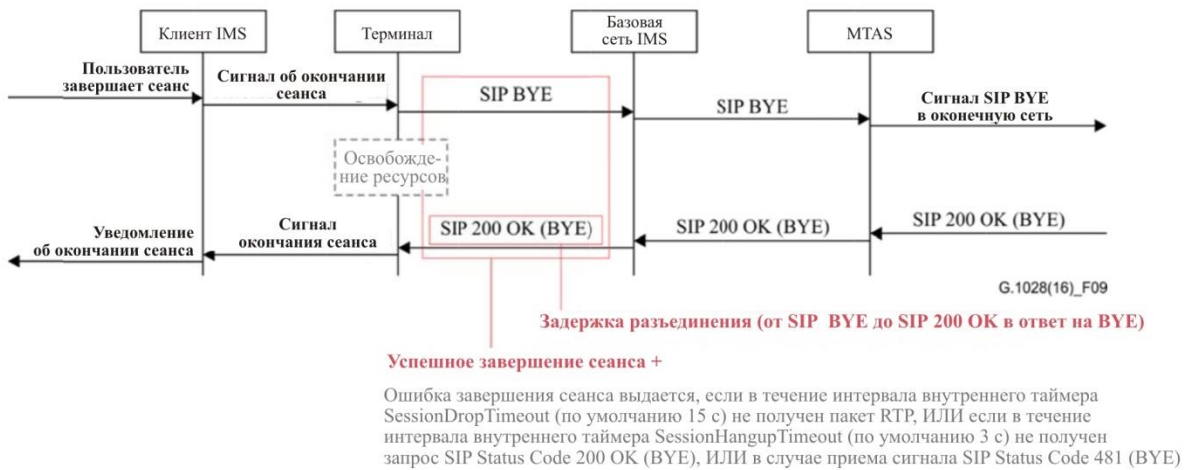
Рисунок 9 – Схема измерения параметров завершения сеанса VoLTE
