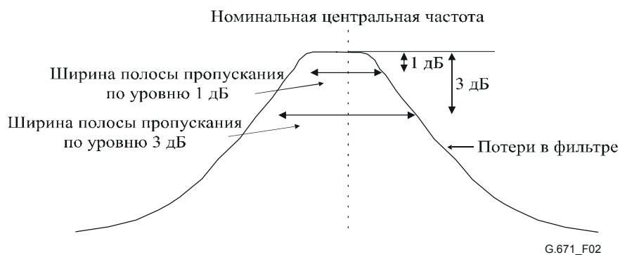
Рисунок 2/G.671 – Иллюстрация ширины полосы пропускания по уровню 1 дБ и 3 дБ
