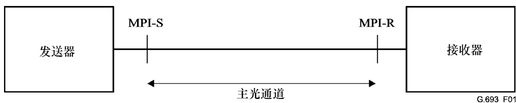
图1/G.693 — 表现出本建议书规定的参考点的光链路例子
