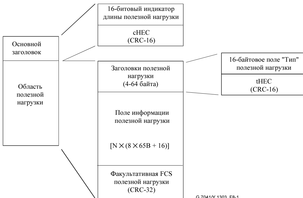
Рисунок 8-1/G.7041/Y.1303 – Формат кадра прозрачной GFP
