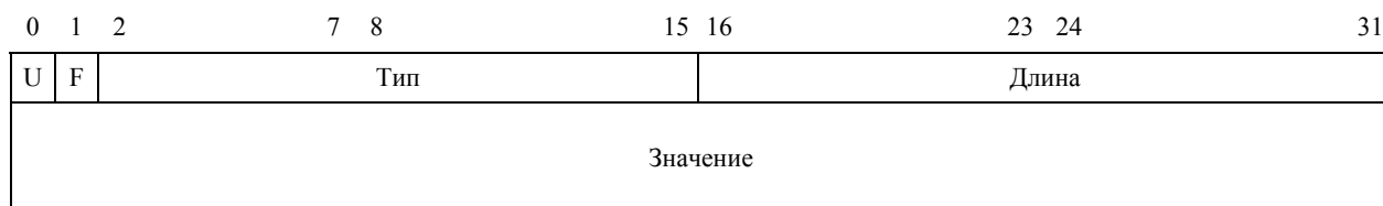
Рисунок 2/G.7713.3/Y.1704.3 – Структура схемы кодирования параметров (TLV)
